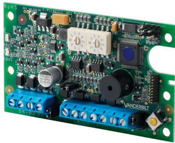
Das erweiterte E-BUS-Gateway von Vanderbilt ist eine neue und interessante Komponente der SPC-Reihe – die innovativste Generation von Einbruchmeldesystemen auf dem Markt. Es ermöglicht die Kommunikation zwischen dem SPC-Controller und einem breiten Spektrum von E-BUS-Peripheriegeräten. Dadurch können Kunden SPC-X-BUS- und E-BUS-Geräte mischen, um ein von SPC verwaltetes hybrides Netzwerk zu bilden.
